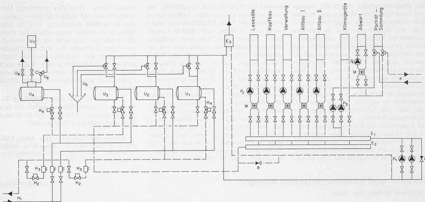
Bild 30. Vereinfachtes Leitungsschema der Heizzentrale
