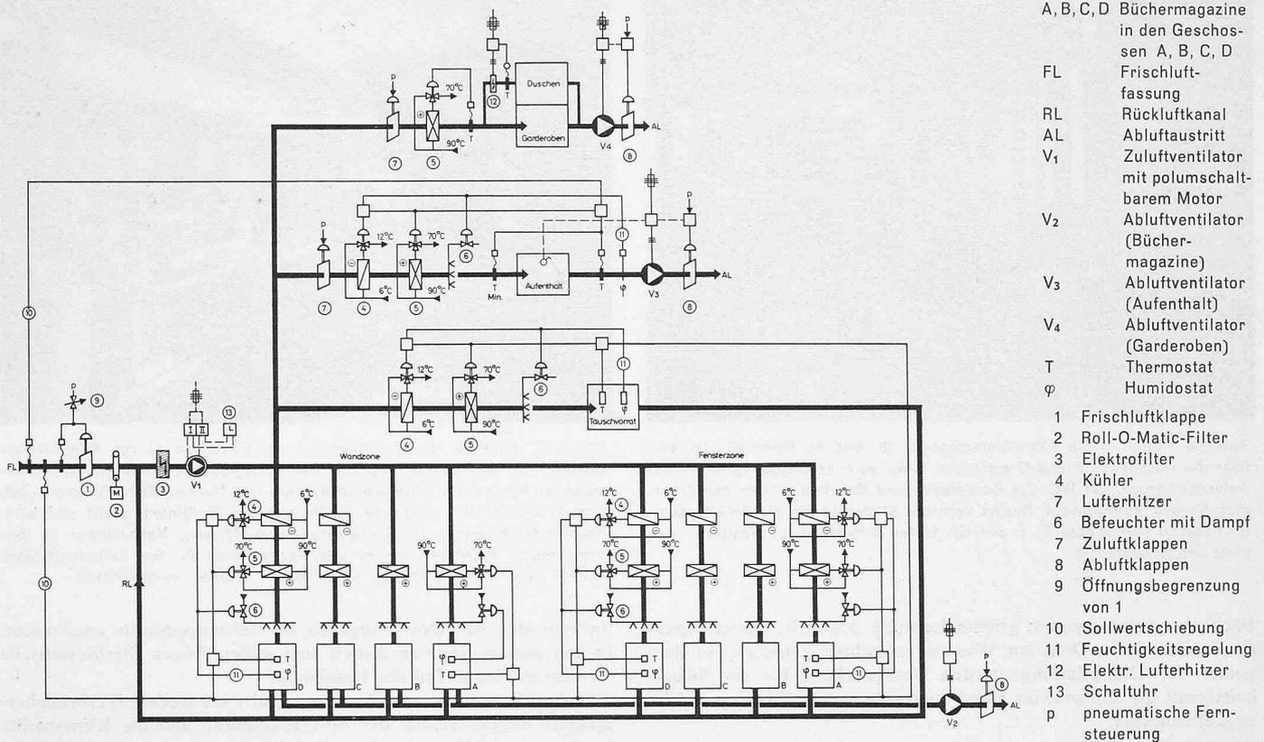
Bild 32. Prinzipschema der automatischen Regelung für die Klimageräte der Gruppe a (Büchermagazine und Nebenräume)
