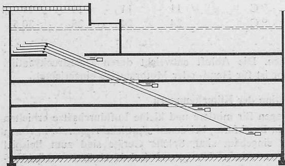
Bild 38. Anordnung der Steigbänder für den Büchertransport, 1:800
