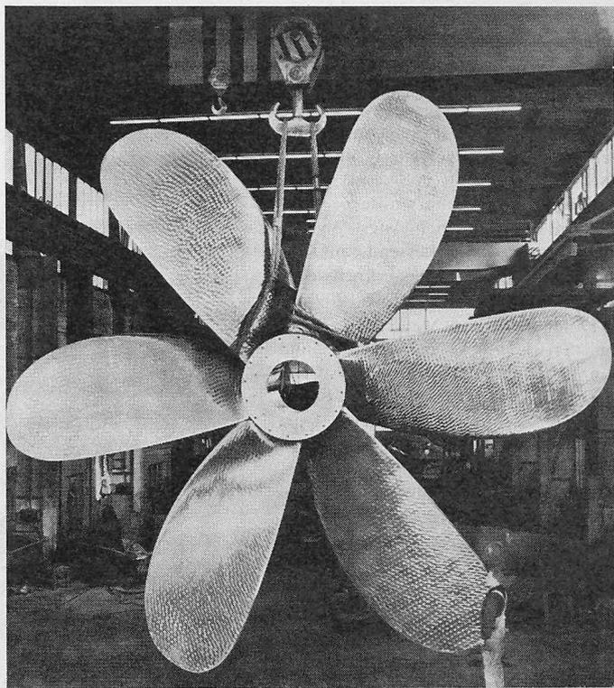
Bild 1. 55-t-Sechsbblatt-Schiffspropeller
