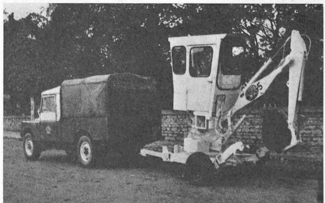
Bild 1. Der Smalley-Bagger 360/5 ist transportbereit
