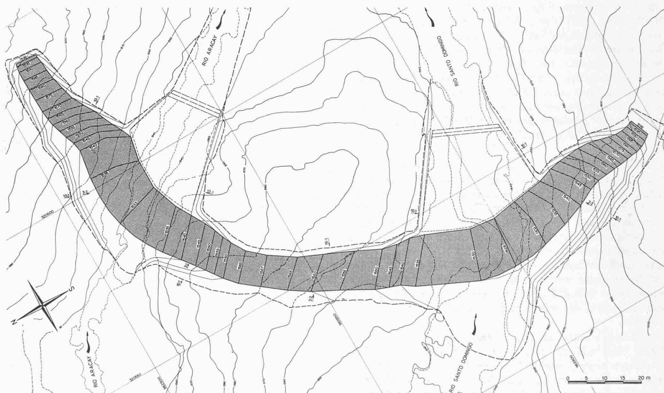
Bild 6. Staumauer Santo Domingo, Aushubplan 1 : 1000
