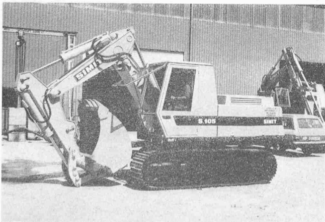
Bild 7. Ansicht des Hydraulik-Baggers Simit S.105 . Gut erkennbar ist der dreiteilige Ausleger
