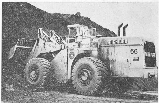
Bild 2. Schaufellader Michigan 475 für Schwereinsatz
