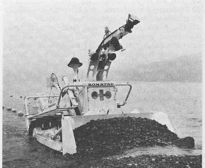
Bild 2. Elektrisch angetriebene Planierraupe für den Unterwassereinsatz
