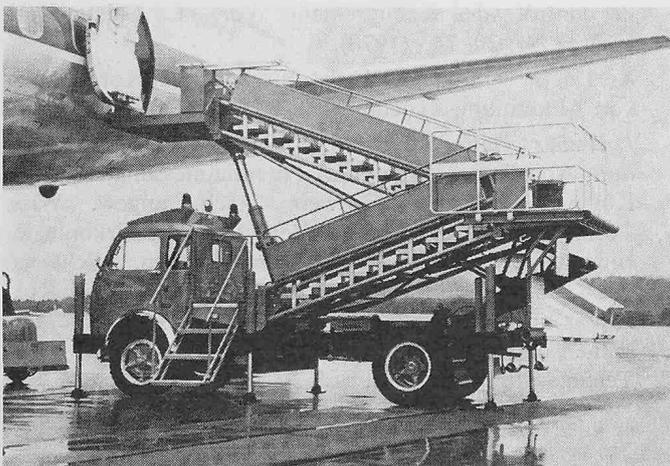
dürfte, wenigstens in der Schweiz, das einzige derartige Rettungsgerät sein. Die Höhenverstellung der Treppe erfolgt über ein vom Fahrzeugmotor angetriebenes Hydrauliksystem. Sie kann von 1 bis 5,5 m stufenlos eingestellt und damit auch bei Grossraumflugzeugen verwendet werden. Bei nächtlichem Einsatz ist der Treppenaufgang beleuchtet.
