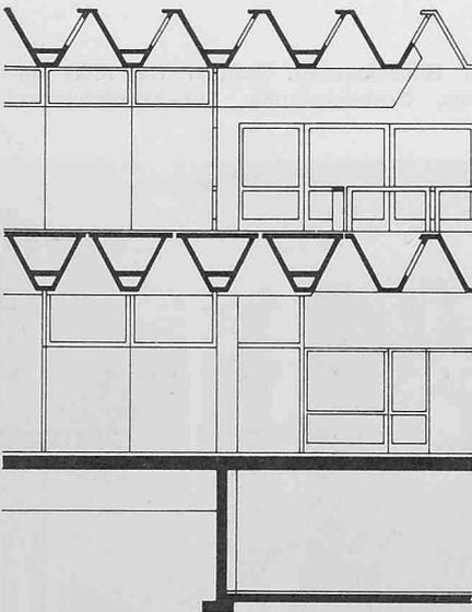
Bild 1. Schnitt durch die Konstruktion des integrierten Lüftungssystems
