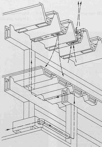
Bild 2. Perspektive der Konstruktion mit integrierter Klimaanlage
