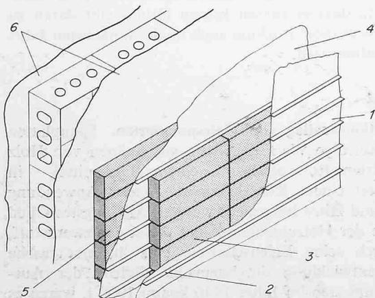
Bild 1. Schematische Darstellung der Behälterwand in Membranbauweise
