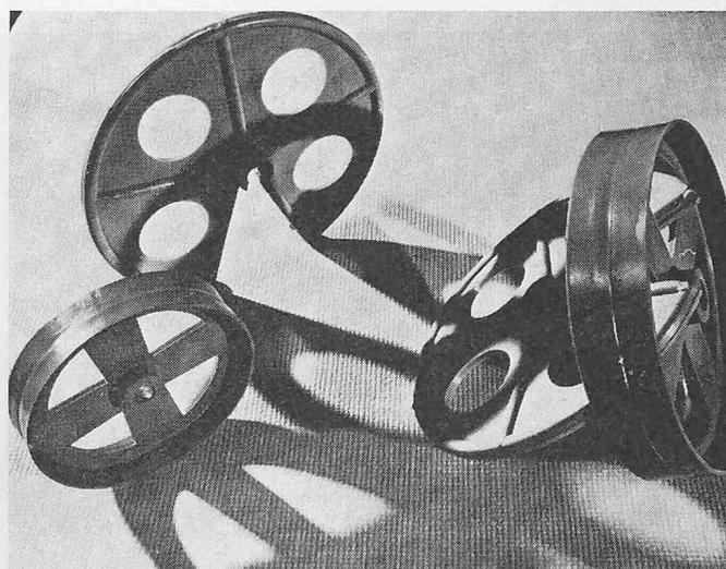
zum Aufkleben auf die Spirale nach dem Zusammenbau der Armierung, und die radförmige Ausführung, welche auf den die Spirale bildenden Draht während der Erstellung des Pfahlkorbes aufgesteckt wird. Sie werden gegossen, so dass ihre Abmessungen konstant sind; das Material ist sehr widerstandsfähig gegen chemische Angriffe, und das Gewicht ist gering.
