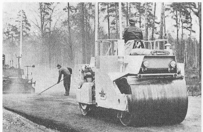
Bild 8. Selbstfahrende Tandem-Vibrationswalze Dynapac CC 40 mit Knicklenkung und fünf verschiedenen Amplituden-Stufen für Erd- und Asphaltverdichtung, Gewicht 10 200 kg, mit Deutz-Dieselmotor von 92 PS. Alle Bilder sind Werkphotos Notz & Co. AG, Biel.
