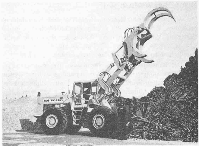
Bild 5. Radlader Typ 1640, ausgerüstet mit einer Greifzange, auf dem Lagergelände der Zellulosefabrik Attisholz
