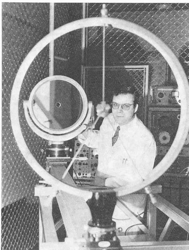
Bild 1. Cassegrain-Teleskop einer Kopfstation der Versuchsstrecke. Im Vordergrund der konvexe Okularspiegel. Das Bild zeigt die Empfangseinrichtung
