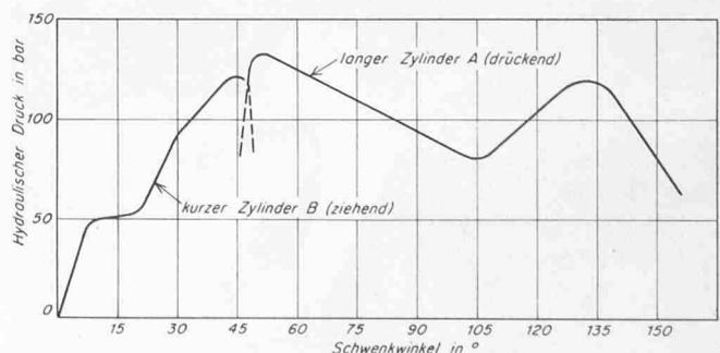
Bild 7. Druckverlauf in den Schwenkzylindern A und B
