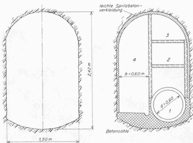
Bild 2 (links). Ausbruchquerschnitt mit Vortriebsmaschine Mini Fullfacer FF 1524; Ausbruchfläche 3,3 m<sup>2</sup>
