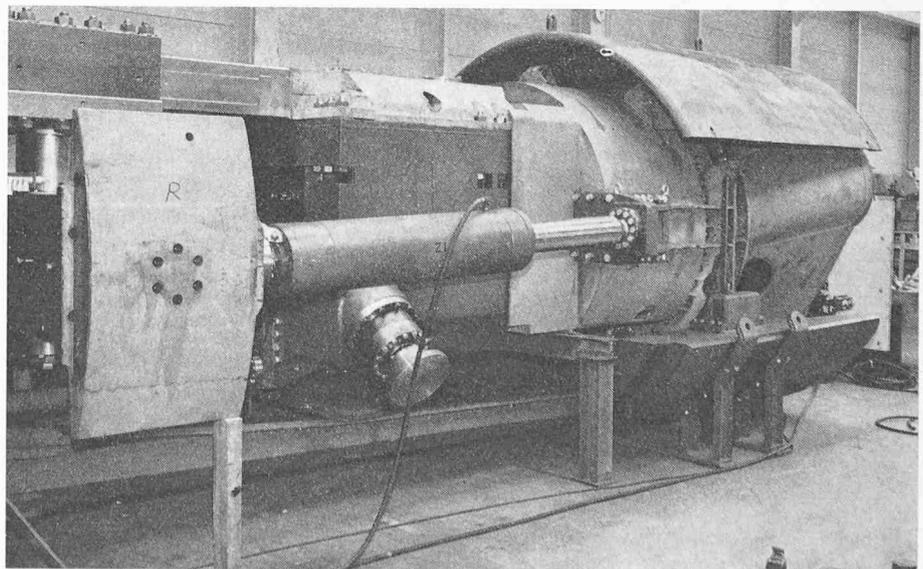
Bild 1. Kreisrunde Vortriebsmaschine Fullfacer FF 340, Ausbruchdurchmesser 3,4 m, während der Werkmontage. Sichtbar sind: Maschinenrumpf, Trommel, Vorschubaggregat, Hilfsabstützung, Schutzdach und Abfördersystem
