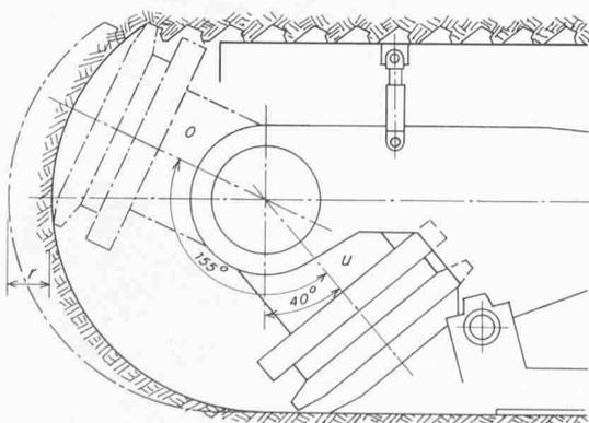
Bild 6. Schwenkbewegung des Fräskopfes, u untere Stellung, o obere Stellung, r grösste Hinterschneidtiefe
