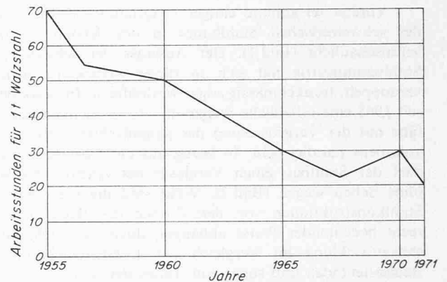
Bild 5. Anzahl Arbeitsstunden, die aufgewendet werden können, um 1 Tonne Material einzusparen. Die Bedeutung der Lohnkosten ist ein eindringlicher Hinweis für die Notwendigkeit arbeitssparend zu konstruieren
