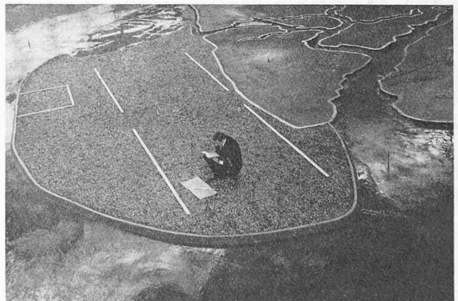
druckluftbetriebener Tide- und Strömungsgenerator bildet in Zeitabständen von  $7\frac{1}{2}$  Minuten Tidewellen nach. Mit dem Modell sollen folgende Fragen abgeklärt werden: Bestimmung des endgültigen Umfangs der Landgewinnungsarbeiten, Voraussage des Einflusses auf die Tidewellen, Veränderungen in den Kanälen und Mündungsgebieten, Untersuchung der neuen Strömungsverhältnisse und der Umlagerungen am Meeresgrund.
