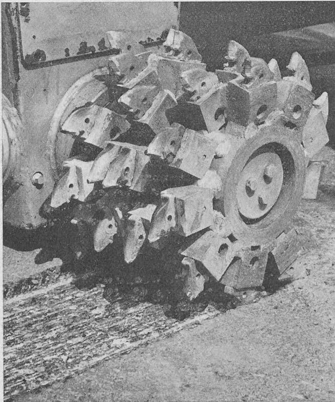
umweltfreundliche Maschine (kein Rauch) vielfältige Verwendung bei Strassenbelags-Reparaturarbeiten, beim Entfernen von Belag längs Randsteinen, bei Schächten, bei Fahrbahnübergängen – kurz dort, wo die herkömmlichen Abschäl- oder Abfräsmaschinen versagen oder der Belag mit Abbauhammer abgebaut werden müsste.
