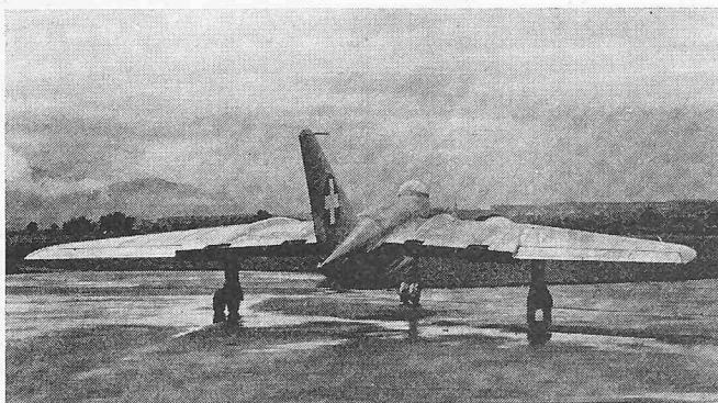
Bild 15. N-20.10. Ansicht von hinten. Gut sichtbar die Austrittsöffnungen der Haupt- und Nebenströme. Man beachte auch die grossflächigen Haupttruder
