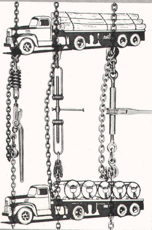
Ladebinder, Drahtseile und Ketten zum Befestigen von Lasten auf Lastwagen
