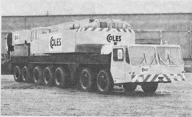
gesteuert werden und horizontal und vertikal unabhängig verstellbar sind. Die geräumige vierplätzig Frontlenkerkabine ist schallgedämpft und schwingungsfrei auf Gummielementen gelagert. Die Abmessungen, Achslasten, Bremssysteme und Beleuchtungsorgane entsprechen den heute gültigen Normen und Vorschriften für schwere Arbeitsmaschinen.
