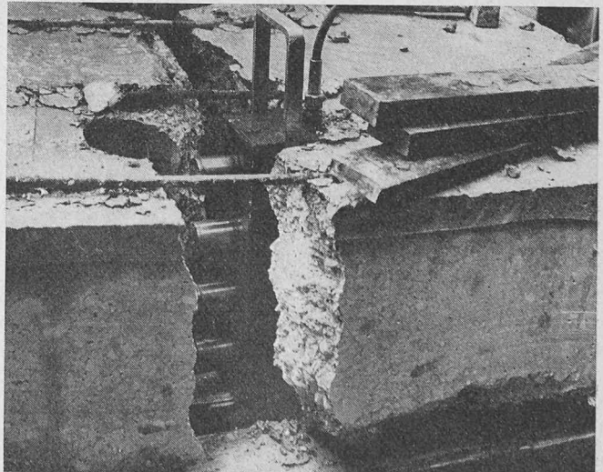
3. Der entzweigerissene Betonblock; vorne ist die stabförmige Presse erkennbar
