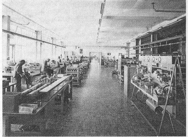
Luftapparate-Abteilung: Revisionen und Reparaturen von ausgebauten Aggregaten
