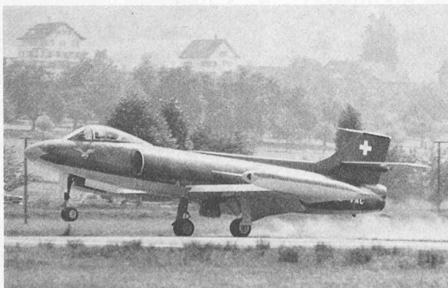
Bild 52. Vorserienmaschine 04 des P-16 bei der Landung in Altenrhein. Es wurden minimale Landerollstrecken von wenig mehr als 300 m erzielt
