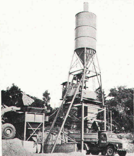
Standard-Betonanlagen AEBI, 4 Typen zwischen 20 \text{ m}^3 und 60 \text{ m}^3 Festbeton pro Stunde.
