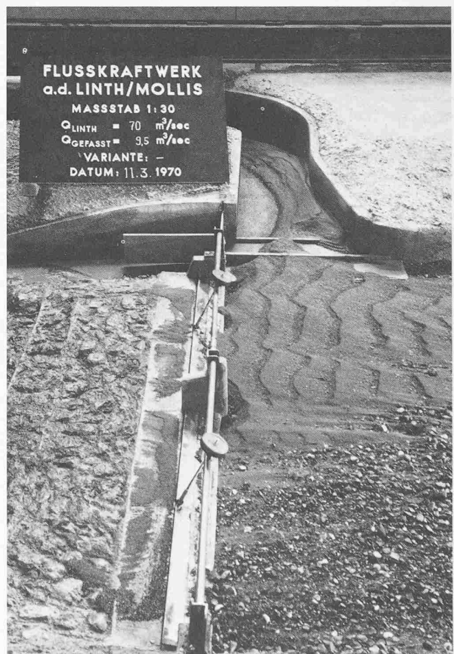
Bild 6. Bei bestehender Fassungsanlage starkes Eindringen von Geschiebe
