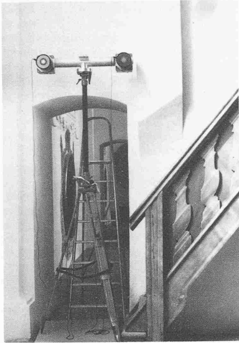
Bild 3. Doppelkammer (links). Zwei Einzelkameras sind so zueinander justiert, dass die Aufnahmerichtungen parallel zueinander laufen und rechtwinklig zur Basis stehen
