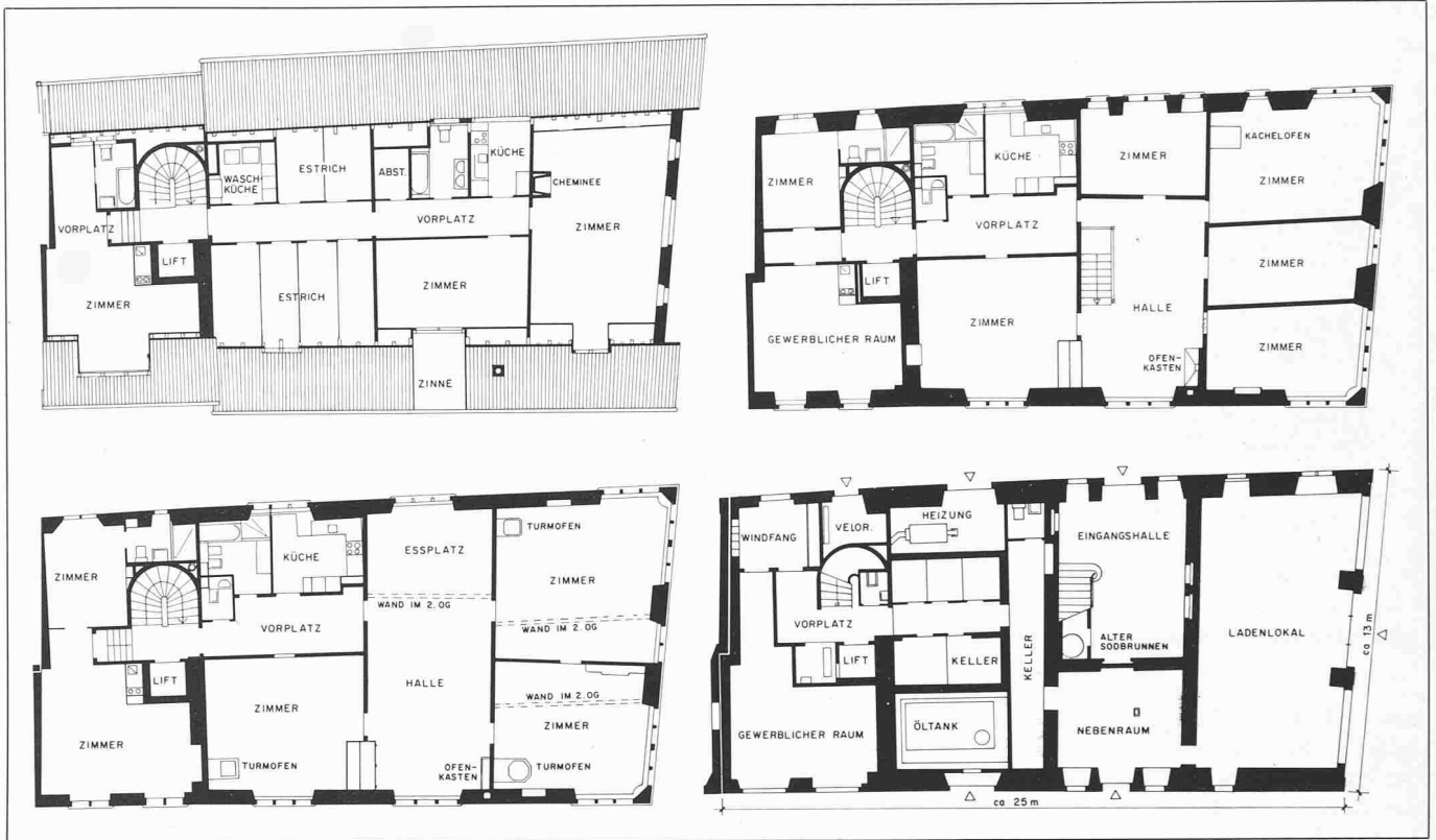
Grundriss Dachgeschoss (oben), Grundriss drittes Obergeschoss; links: das Sigristenhaus, rechts: das «Neuhaus»
