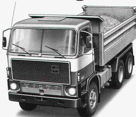
Volvo CH 230: Gesamtgewicht 25 resp. 28 t. Radstand nach Wunsch, 2,3 m breit. Ganzstahl-Sicherheits-Kippkabine mit Ruhebelt oder Kurzkabine. Volvo-Dieselmotor mit 506 DIN/PS netto mit Abgasturbolader, 16-Gang-Getriebe oder auf Wunsch mit Automat.
