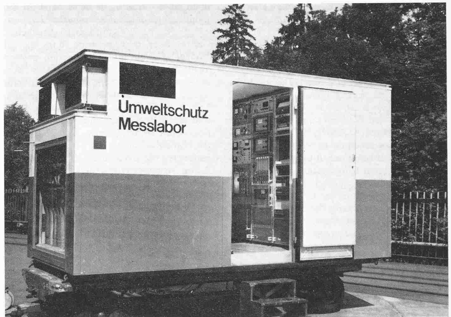
Bild 1. Mobiles Umweltschutz-Messlabor für Immissions- und Emissionsmessungen
