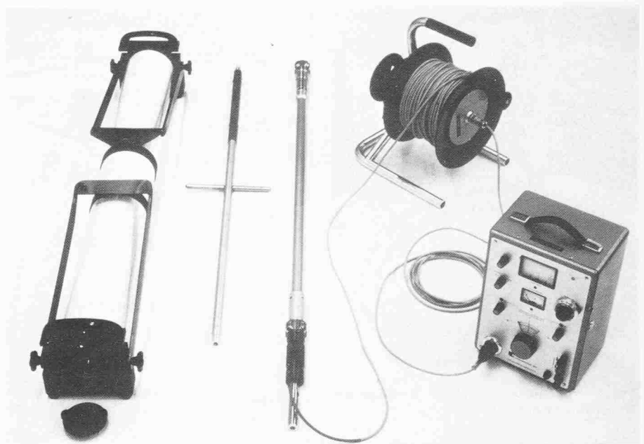
Bild 17. Das Gleitmikrometer-ISETH mit Eichlehre, Bedienungsgestänge, Messsonde und Ableseeinheit
