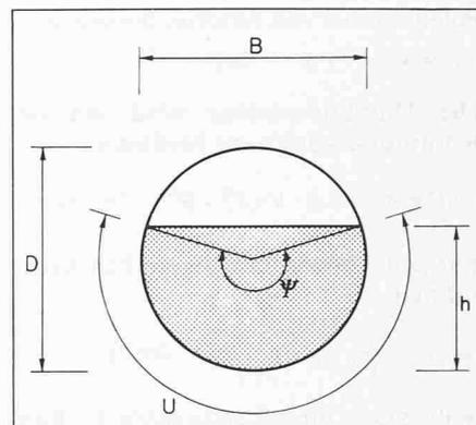
Bild 1. Bezeichnung der geometrischen Daten beim Kreisprofil
