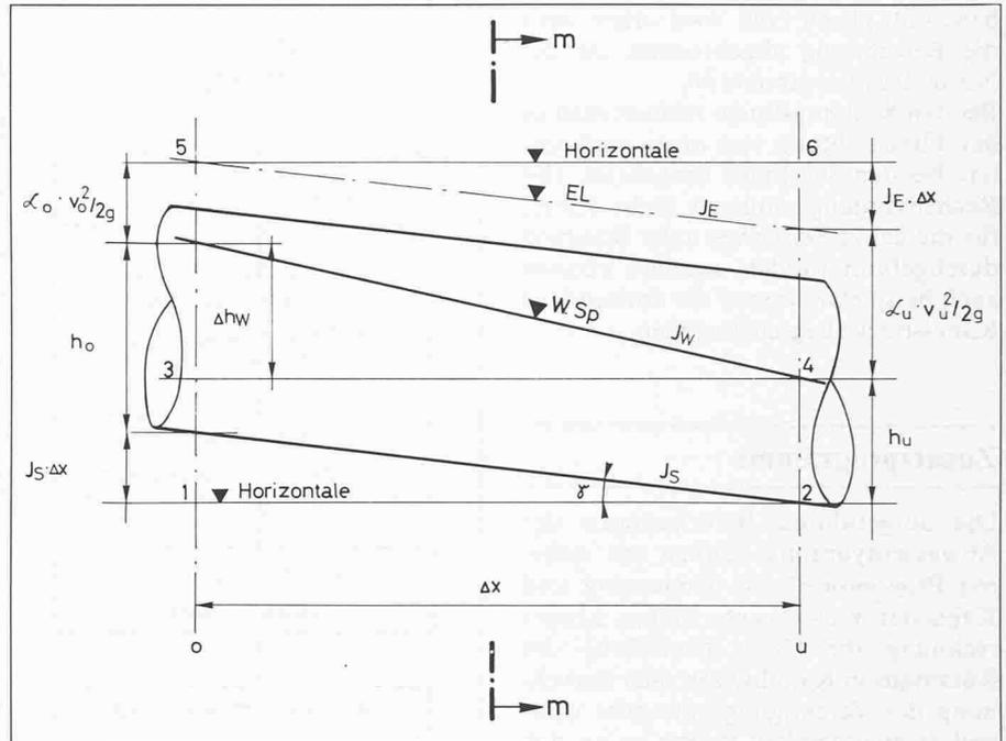
Bild 3. Darstellung des Bernoulli-Satzes für einen Rohrleitungsquerschnitt
