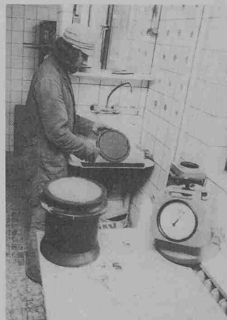
Neuer Luftgehaltsprüfer Porotest für Beton. Alle Bedienelemente, das grossflächige Manometer und eine Wasserkammer sind in den kompakten Gerätekopf eingebaut, der durch zwei Schnellverschlüsse mit dem Probenbehälter verspannt wird
