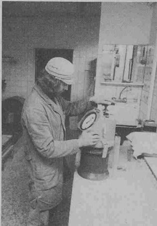
Statt des Gerätekopfes braucht nach der Prüfung nur der Behälter-Zwischendeckel gereinigt werden. Wie der Probenbehälter besteht er aus hochfestem Polyamid, die Betonreste lassen sich leicht abschwemmen
