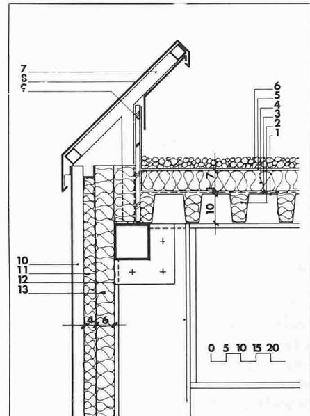
Konstruktion des Dachabschlusses beim Lagertrakt.
