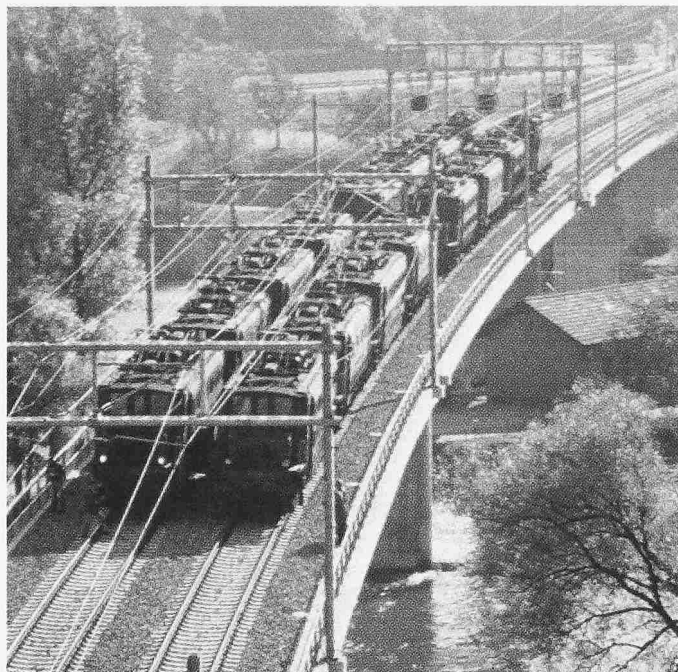
Bild 4. Bremsversuch mit 16 Lokomotiven
