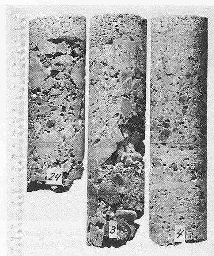
Bild 3. B-065 Bohrkern aus Stampfbeton, Baujahr 1925. Foto EMPA 57751
