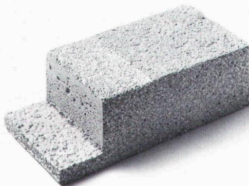
Dass der mineralische **rhodipor** Dämmputz kein Kondenswasser bildet, dass er ebenso atmungsfähig ist wie Backstein ( $\mu$  6.8) und eine Wärmeleitzahl von  $\lambda$  0.056 W/mK (Rechenwert nach SIA Norm 279)
