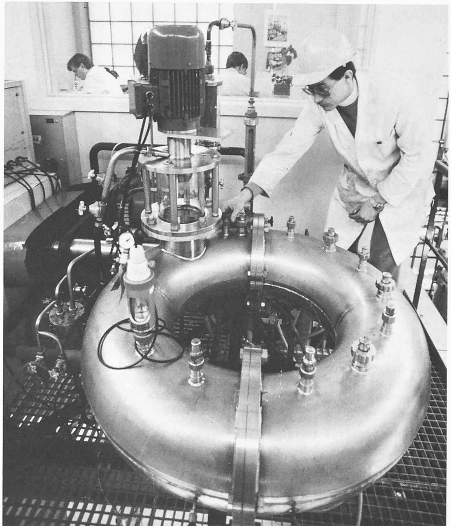
Torus-Bioreaktor (Eigenentwicklung vom Institut für Verfahrens- und Kältetechnik ETHZ; Prof. Widmer). Kreisförmiger Bioreaktor mit einem Fassungsvermögen von 100 l, geeignet zur Kultivierung von Mikroorganismen in hoch viskosen Nährmedien. Links im Bild sichtbar die horizontalliegende Antriebswelle, im Zentrum der vertikal stehende Schaumabscheider. Die am Reaktor angebrachten Stützen ermöglichen die Aufnahme von Messprofilen
