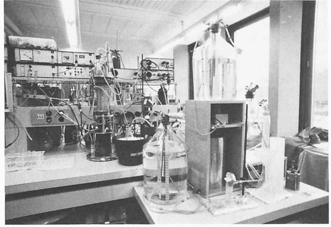
Labor-Kleinreaktor 2 Liter. Kleinanlagen werden hauptsächlich zu folgenden Aufgaben beigezogen: Biochemische Fragestellungen, Erarbeitung von Prozessgrundlagen, Ausbildung. Im Zentrum des Bildes der Bioreaktor, dahinter die zugehörige Mess- und Regeltechnik, im Vordergrund die Vorratsgefässe für Nährmedien
