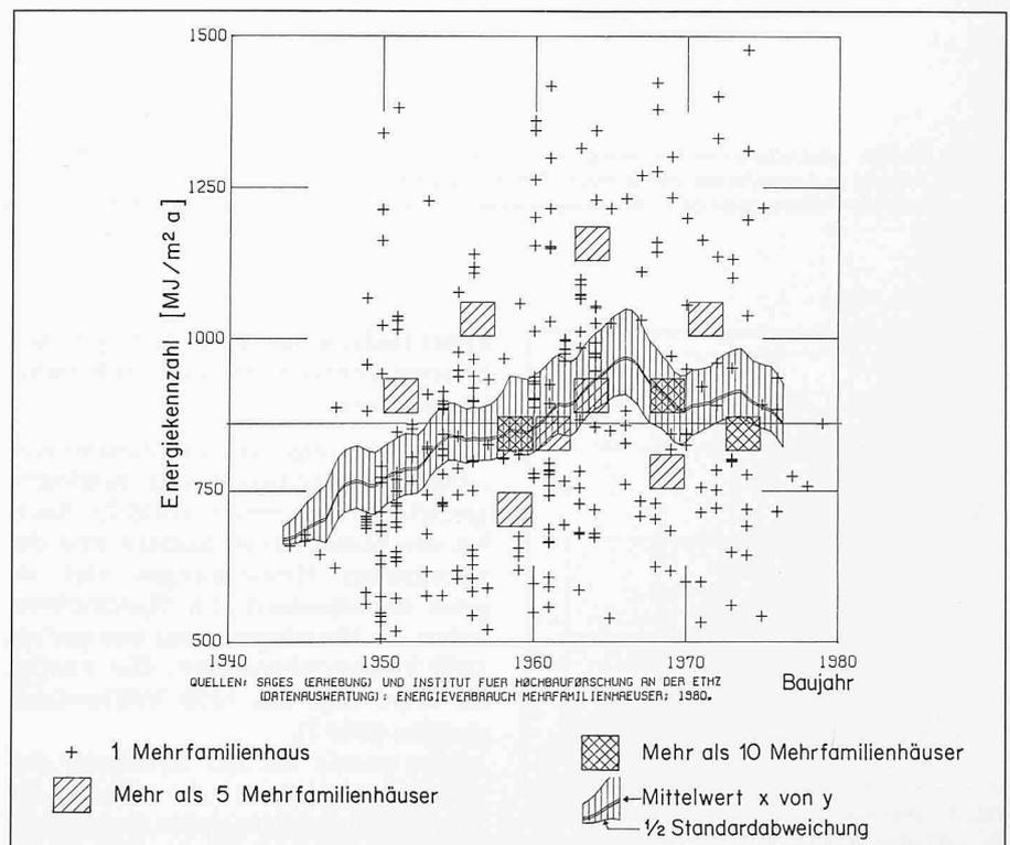
Bild 1. Energieverbrauch in Abhängigkeit des Baujahres. Totale Energiebezugsfläche: 761 800 m<sup>2</sup>
