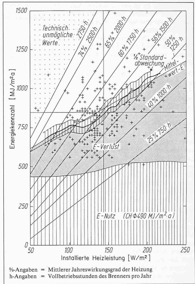
Bild 2b (rechts). Aufteilung von Nutzenergie und Verlusten in Abhängigkeit von E-Kennzahl und spezifischer Heizleistung. Berechnungsannahmen: Feuerungstechnischer Wirkungsgrad 88%; Strahlungsverluste 3%; Innere Auskühlung 1,5%
