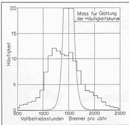
Bild 3. Brennerbetriebsstunden beim Kombikessel. Verteilung der Häufigkeit
