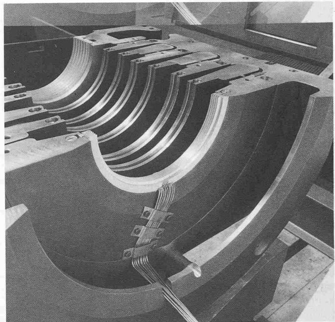
Bild 14. Messlabyrinth im Gehäuseunterteil
