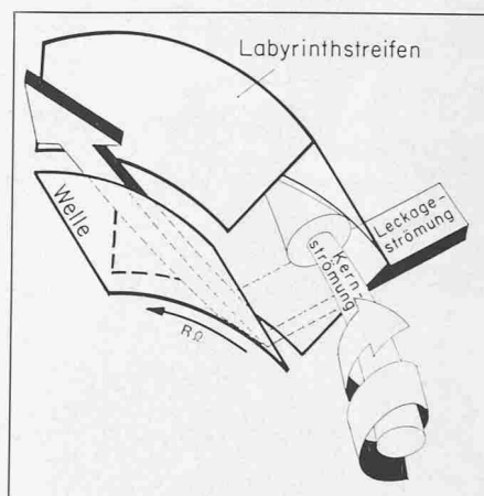
Bild 11. Strömung im Labyrinth
