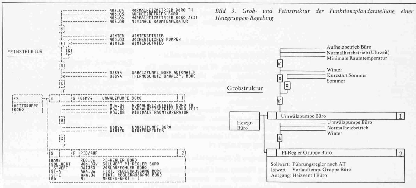
Bild 3. Grob- und Feinstruktur der Funktionsplandarstellung einer Heizgruppen-Regelung
