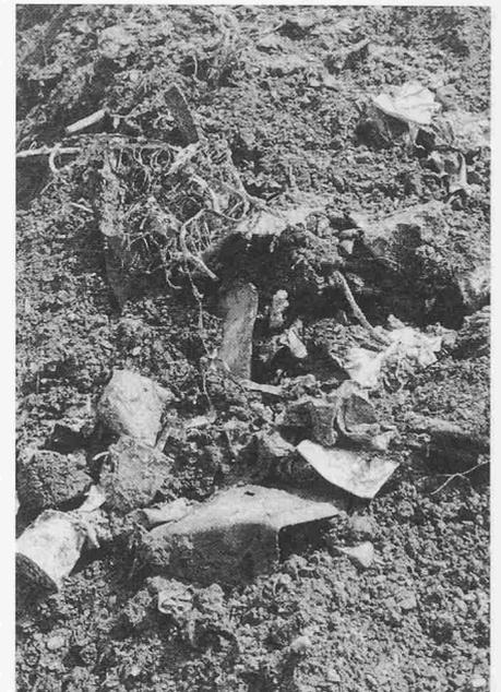
Bild 1. Kehrriechtschlacke, wie sie aus der Verbrennungsanlage anfällt (Nahaufnahme)
