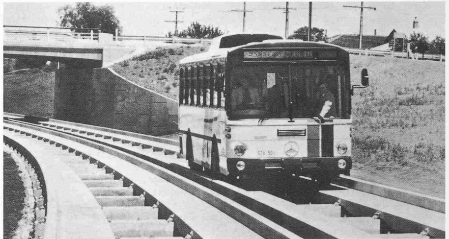
Bus auf dem ersten Streckenabschnitt des O-Bahn-Trassees nordöstlich von Adelaide (Australien)
