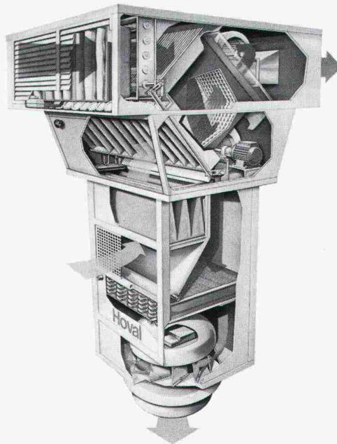
**Hoval HexaFlow.** Rotations-Wärmetauscher für regenerative Wärmerückgewinnung aus Abluft. Dieser äusserst wirtschaftliche Wärmetauscher kommt überall dort zum Einsatz, wo in lufttechnischen Anlagen sowohl ein Wärme- bzw. Kälteausch als auch eine Feuchtigkeitsübertragung gewünscht wird.
