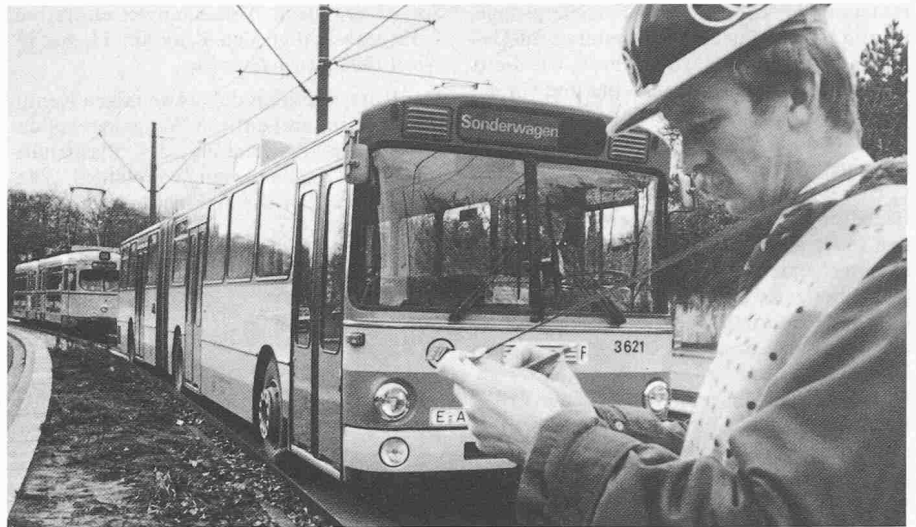
Autobus und Strassenbahn können auf der Essener Teststrecke auf gemeinsamer Gleisstrecke fahren
