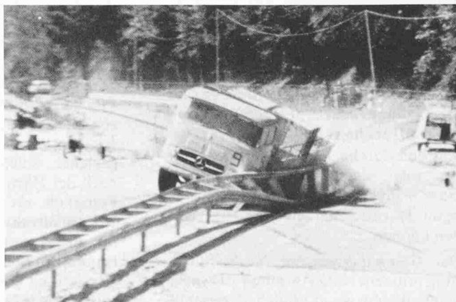
Bild 5. Sehr gute Umlenkung des Versuchslastwagens durch die doppelte Distanzleitschranke (10 t, 68 km/h, 15°)
