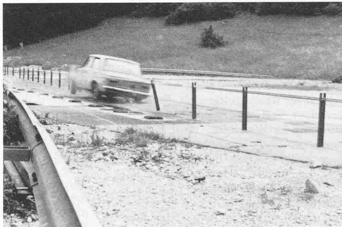
Bild 3. Personenwagenversuch an der Seilleitschranke (1 t, 98 km/h, 20°)
