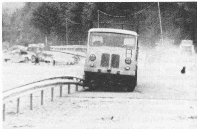
Bild 4. Überquerung der doppelten Leitschranke durch den Versuchslastwagen (10 t, 68 km/h, 15°)
