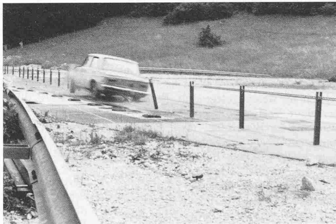
Bild 3. Personenwagenversuch an der Seilleitschranke (1 t, 98 km/h, 20°)
