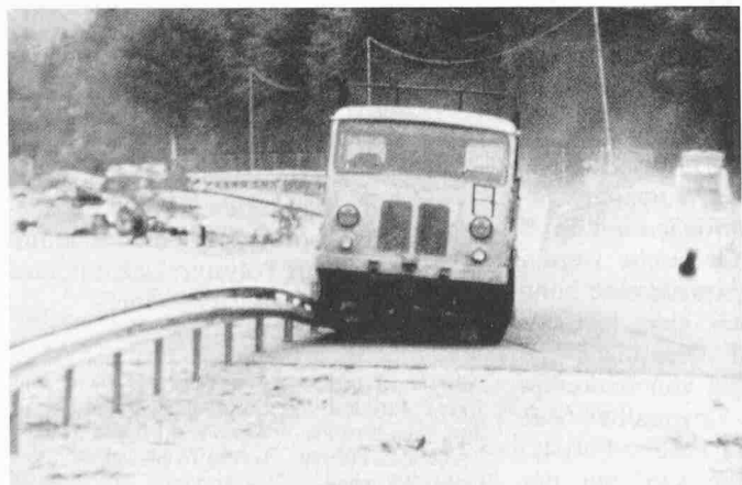
Bild 4. Überquerung der doppelten Leitschranke durch den Versuchslastwagen (10 t, 68 km/h, 15°)
