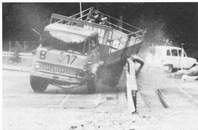
Bild 1. Lastwagenversuch B 17 (5,6 t, 71 km/h, 15°) an der Leitschranke mit Planke Profil A und Handlauf
