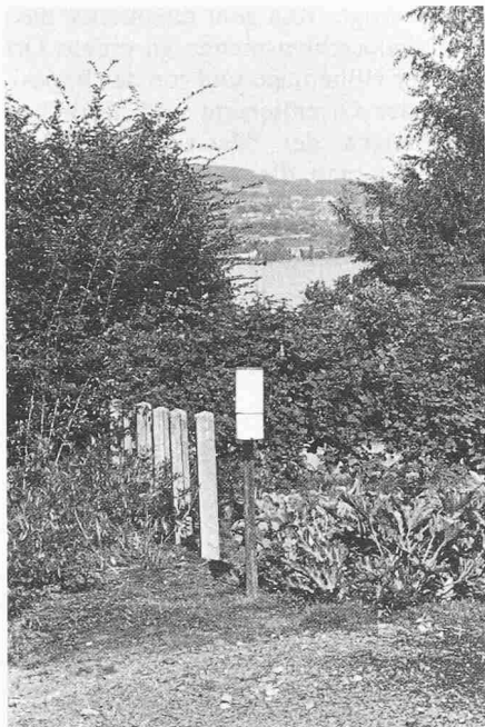
Niederschlagsmessplatz der Station Horgen mit genormtem Tagessammler des Klimamessnetzes der Schweizerischen Meteorologischen Anstalt (445 m ü.M.). – Hier wurde am 20. Mai 1906 mit 192 mm der grösste Tagesniederschlag im Kanton Zürich seit 1881 gemessen.
