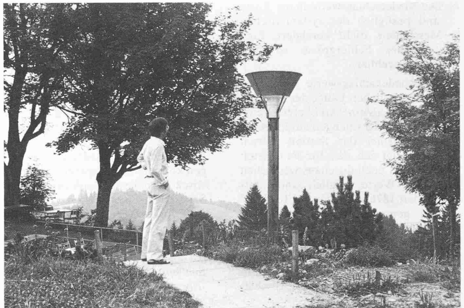
Die Station Bachtel ist mit 1110 m ü.M. der höchstgelegene Niederschlagsmessplatz im Kanton Zürich. Aufgrund der Gipffelage sind die Messungen besonders dem störenden Einfluss des Windes ausgesetzt. Um diesen Einfluss möglichst klein zu halten, werden die Regenmesser in solchen Fällen mit einem Windschutzring versehen.
