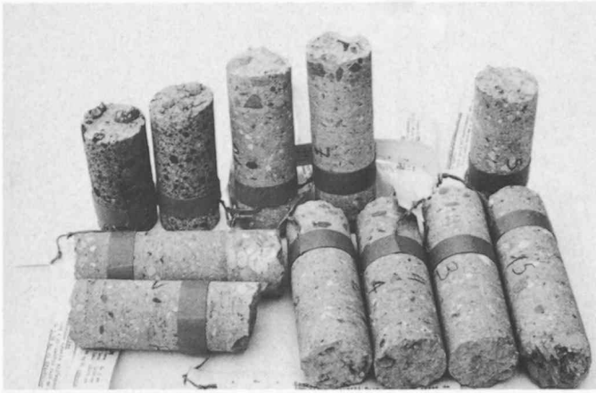
Bild 4. Spritzbeton-Kleinbohrkerne (50 mm Durchmesser)
