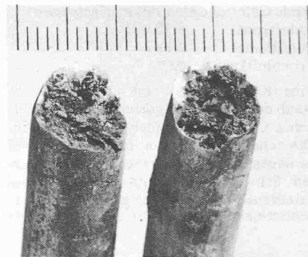
Bild 1. Gebrochene Bügel mit der für spannungsrisikostypischen verformungsarmen Bruchfläche. Lediglich am Rand ist der noch intakte Werkstoff zu erkennen.
