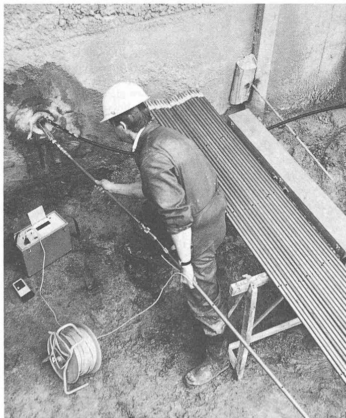
Bild 4. Einbau der Sonden mit dem Gleitmikrometer ISETH auf der Baustelle
