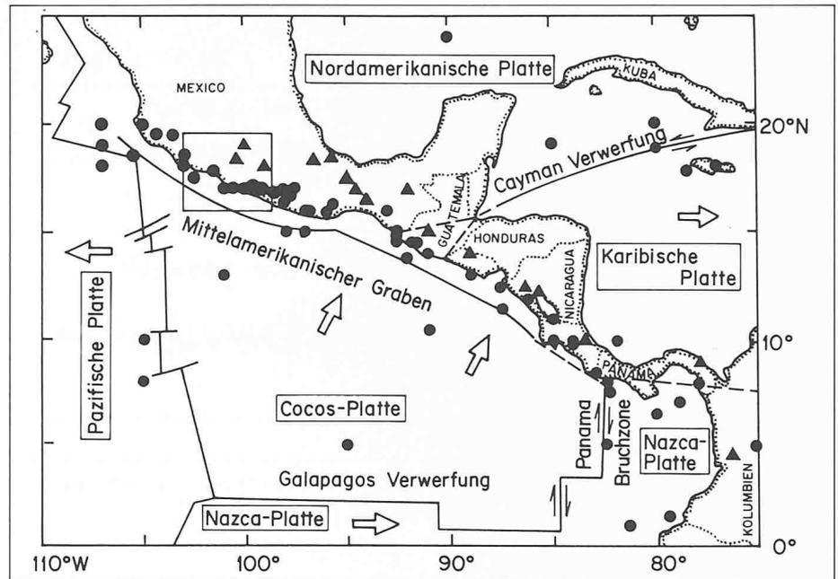
Bild 2. Platten- und seismotektonische Situation im mexikanisch-mittelamerikanischen Raum. Die in diesem Gebiet seit 1897 mit Magnitude  $M_L > 7$  aufgetretenen Erdbeben konzentrieren sich entlang dem mittelamerikanischen Graben, wo die Cocos-Platte unter die nordamerikanische Platte und die karibische Platte taucht. Kreise kennzeichnen flachliegende Erdbebenherde mit einer Herdtiefe  $H < 60$  km, Dreiecke solche mit  $H > 60$  km (aus [4],  $M_L$  = local magnitude, Richter Magnitude)
