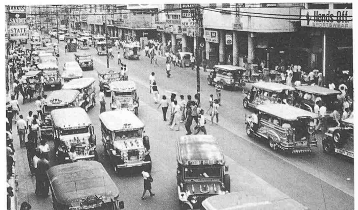
Bild 3. Der «Jeepney», mit einem Dach und zwei Längsbänken versehen, ist für den Transport von 15 bis 17 Passagieren umfunktioniert
